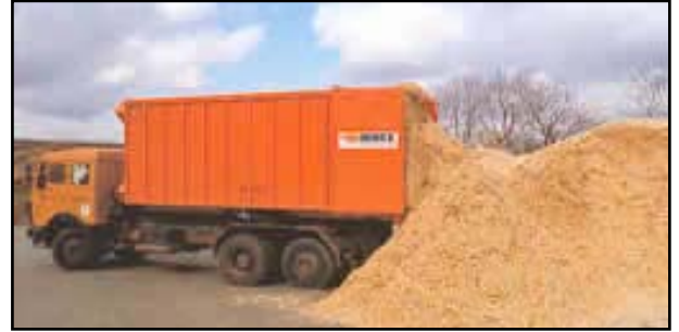
Durch das Herausdrücken fällt das Material breiter und kann sich viel höher als beim Kippen aufbauen, was für eine Mehrfachentladung wichtig ist.
