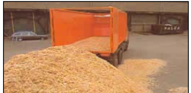
Im Normalbetrieb bleibt bei losem Schüttgut nur eine gut fingerdicke Restschicht zurück.
