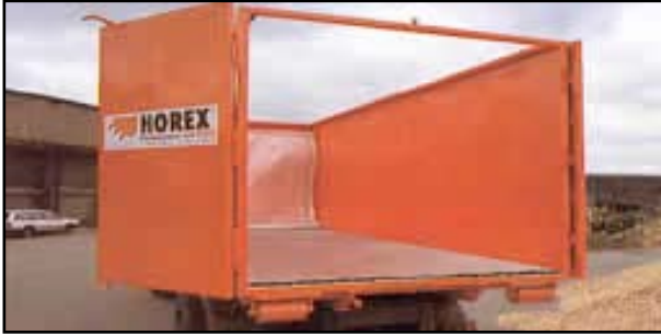
Ein HOREX® Fahrzeugboden besteht aus flachen, leichtgewichtigen Kunststoff- oder Aluminiumprofilen.
