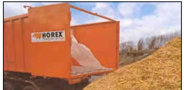
Beliebige Materialmengen können durch eine Schürze voneinander sauber getrennt werden.
