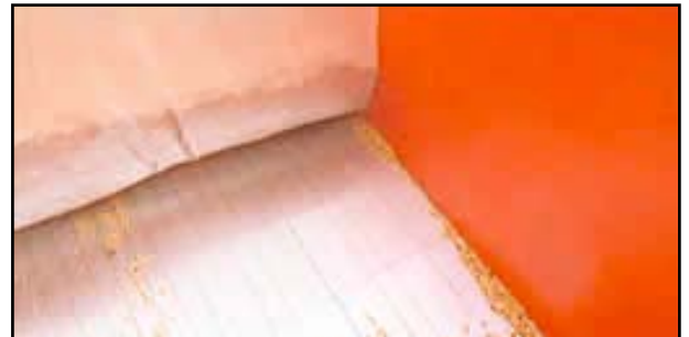
Eine mitlaufende Schürze schiebt den Boden besenrein.
